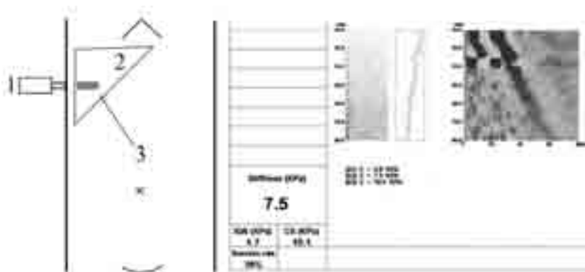
Рис. 2. Схема проведения транзистентной эластографии печени. 1 – эластографический датчик; 2 – паренхима печени; 3 – объем зоны измерения 40 \times 10 \text{ мм}^3 .
